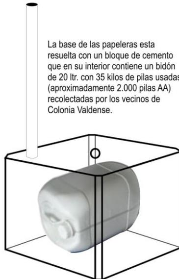
La base de las papeleras esta resuelta con un bloque de cemento que en su interior contiene un bidón de 20 ltr. con 35 kilos de pilas usadas (aproximadamente 2.000 pilas AA) recolectadas por los vecinos de Colonia Valdense.
